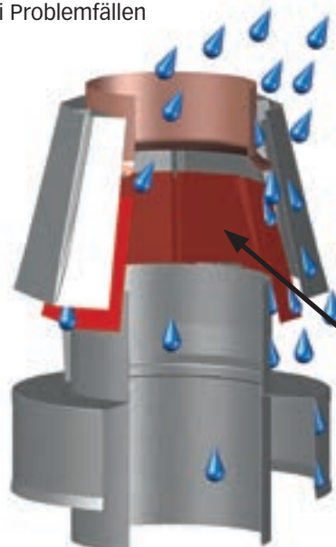
Typ Regulator mit doppeltem Schutzmantel
